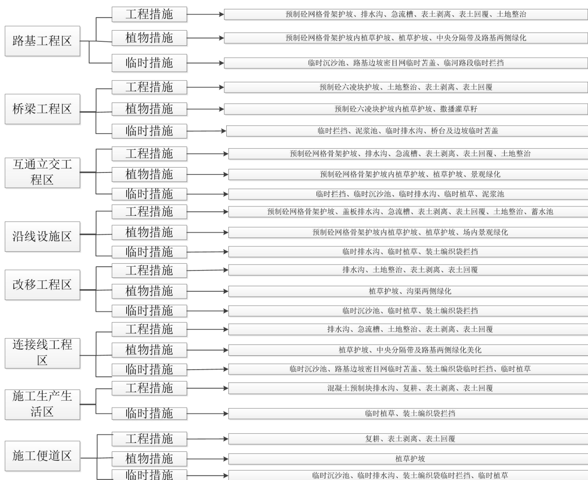
图 3-6 工程实际的水土保持措施体系框图
